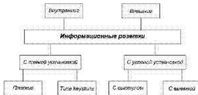
Рис. 73. Варианты конструктивной реализации информационных розеток
